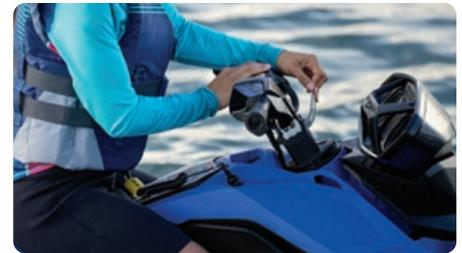
**Guidon avec bloc d'élévation réglable**
